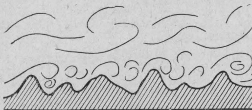
Рис. 43. Схема обтекания выступов шероховатости турбулентным потоком при относительно больших \frac{\Delta}{d}
