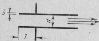
Внутренний вход в трубу (нескругленный)
