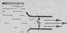
Скругленный вход в трубу без торцевой стенки
